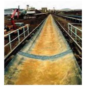
Новейшая технология соединения конвейерной ленты «Super-Screw» позволяет соединять ленту при любых погодных условиях в труднодоступных местах и без квалифицированного персонала. Простота и удобство установки без использования горячей вулканизации и различных клеев делает стыковку поистине быстрой и легкой. Технология соединения выполнена таким образом, что лента
