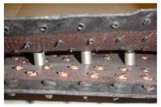
Соединение «Super-Screw» состоит из многослойного тканевого каркаса, покрытого высокопрочной резиной. Эта резина содержит специальный корд, благодаря которому двухстороннее направление волокон обеспечивает высокую прочность на разрыв. Имеются разные типы исполнения: износостойкая, жароустойчивая, маслостойкая, белая FDA или невоспламеняющаяся.
